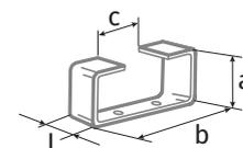
**o Flachkanalverbinder mit einer Klappe FKVK**
