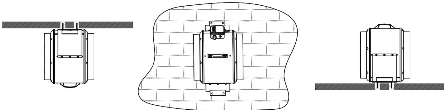
Verbinden Sie die Lüftungsrohre mit entsprechendem Durchmesser mit dem Ventilator (Anschlüsse müssen luftdicht sein). Die Luftstromrichtung im System muss mit der Pfeilrichtung auf dem Aufkleber des Ventilators übereinstimmen.
