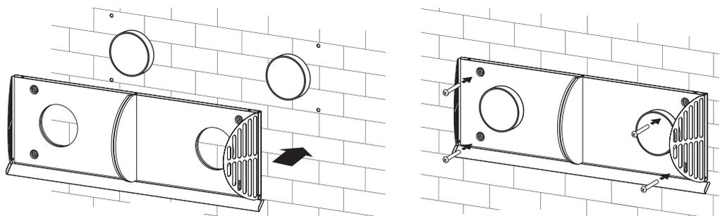
Setzen Sie die Abdeckung der Haube ein und befestigen Sie diese mit den 5 Schrauben.
