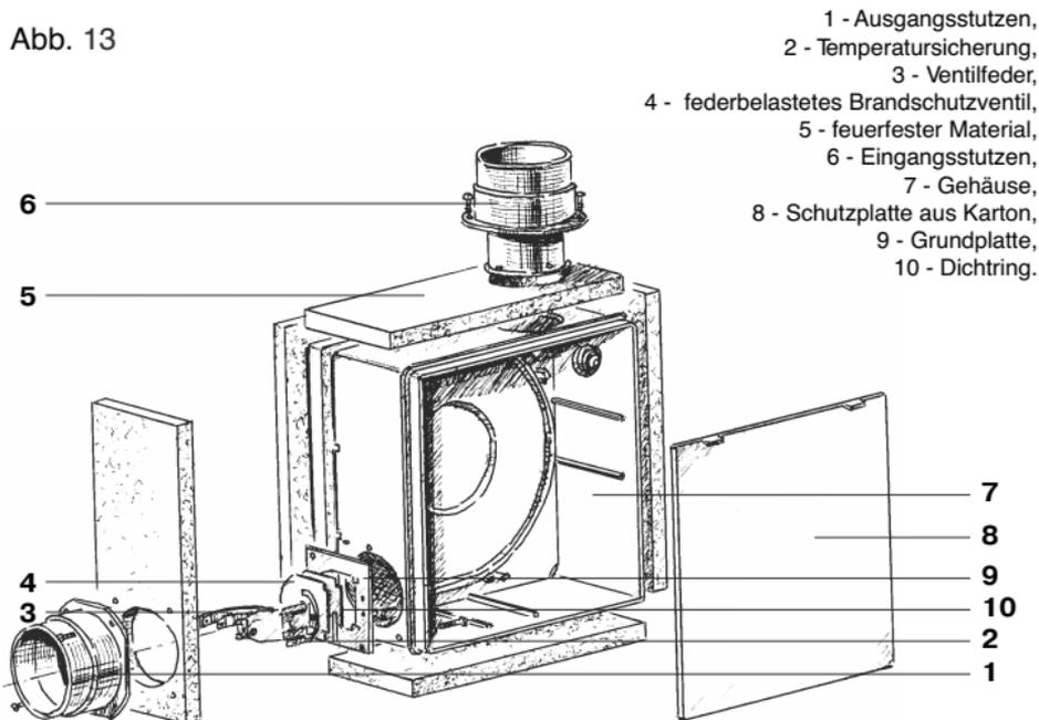
Das Brandschutzgehäuse BF 80 (BFL, BFR, BFD) (Abb. 13) verhindert Feuer- und Rauchausbreitung im Raum durch die Luftkanäle.
