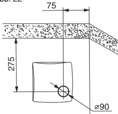
Wählen Sie eine der vier Montageoptionen unter der Berücksichtigung der Position zur Decke und zur Seitenwand (Abb. 19-22). Die Befestigungslöcher anzeichnen und bohren.
