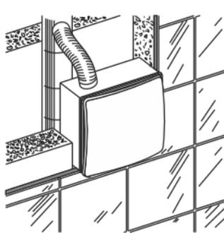
Montagebeispiele des Lüfters Valeo-BP auf den Montagehaltern siehe Abb. 29-32. Die Lüfter Valeo-BP und Valeo-BF sind in 2 Stufen montiert: Montage des Gehäuses und Endmontage.
