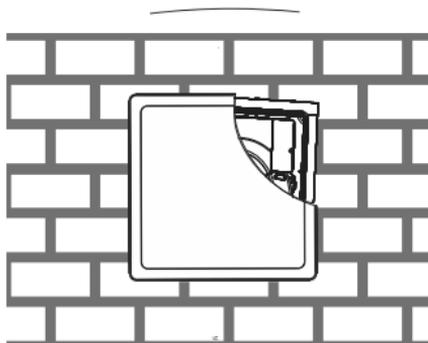
Nach Montage des Gehäuses und dem Ende der Bauarbeiten setzen Sie das Ventilatormodul in das vormontierte Gehäuse ein:
