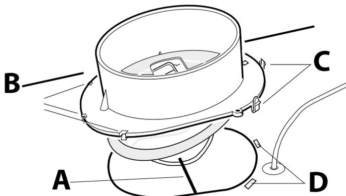
Setzen Sie den Flansch mit Klappe **A** in die Abluftöffnung der Küchenhaube ein. Um die Flanschhaken **B** einzusetzen, müssen sie unter den Rand des Lochs eintreten, dann wird der Flansch mit den Riegeln **C** in den Löchern **D** befestigt.
