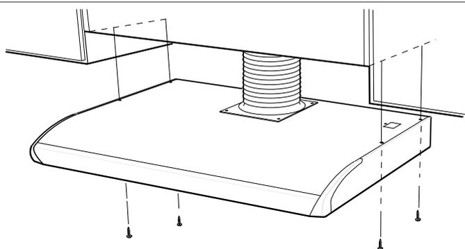
Die Haube ist unter oder in den Küchenschrank montiert. Das Gerät kann auch mit Konsolen montiert werden, die als Zubehör erhältlich sind.
