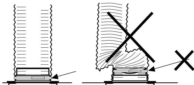
**WARNUNG!** Stellen Sie bei Verwendung flexibler Lüftungsrohre sicher, dass die Verbindung zum Flansch sicher ist und sich nicht verbiegt.
