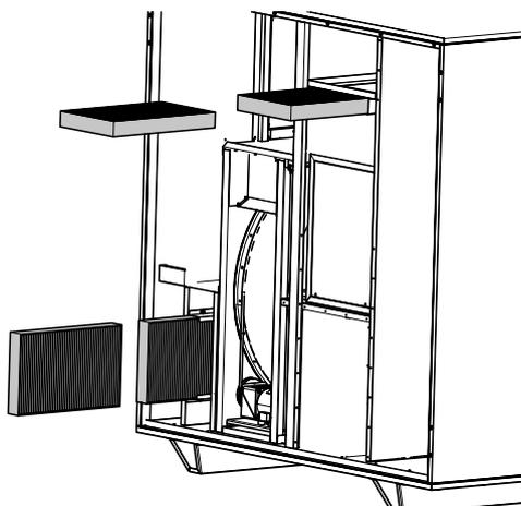
Nehmen Sie die Wartungsblende ab, um Zugang zum Wärmetauscher zu erhalten.
