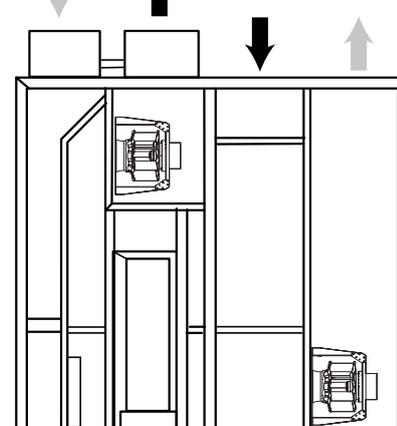
Bei der Montage der Anlage ist ein ausreichender Wartungszugang zu berücksichtigen. Die Mindestabstände zwischen der Anlage und den Wänden sind in den folgenden Abbildungen dargestellt:
