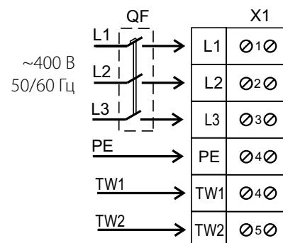
Схема подключения вентиляторов Box-F(I) 40x20 4E; Box-F(I) 50x25 4E; Box-F(I) 50x25 4E; Box-F(I) 50x30 6E; Box-F(I) 50x30 6E; Box-F(I) 60x30 4E; Box-F(I) 60x30 6E; Box-F(I) 60x35 4E; Box-F(I) 60x35 6E с однофазным двигателем
