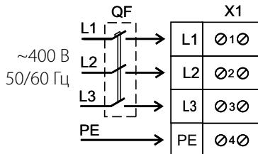
Схема подключения Box/Box-I 50x30 4D (второй вариант), Box/Box-I 60x30 4D; Box 70x40 4D; Box 80x50 4D с трехфазным двигателем
