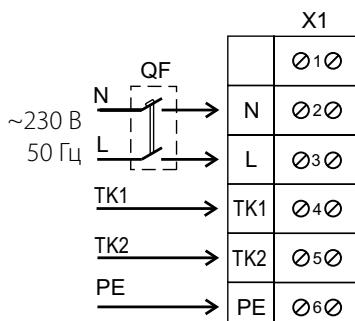
Схема подключения вентиляторов Box 60x35 4D; Box-F(I) 40x20 4D; Box-F(I) 50x25 4D; Box-F(I) 50x30 4D; Box-F(I) 60x32 6D; Box-F(I) 50x30 6D; Box-F(I) 60x30 6D; Box-F(I) 60x30 6D; Box-F(I) 70x40 4D; Box-F(I) 70x40 6D; Box-F(I) 80x50 4D; Box-F(I) 80x50 6D; Box-F(I) 80x50 8D; Box-F(I) 90x50 6D; Box-F(I) 90x50 8D; Box 100x50 4D; Box 100x50 6D; Box-F(I) 100x50 6D; Box-F(I) 100x50 6D
