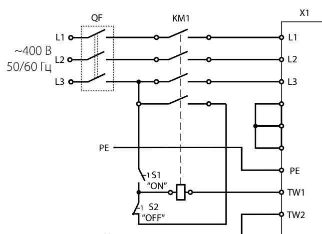
X1 – колодка клеммная, QF – автоматический выключатель, KM1 – магнитный пускатель, S1, S2 – кнопки управления (QF, KM1, S1, S2 в комплект поставки не входят).
