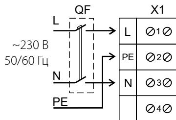
Схема подключения Box/Box-I 50x30 4D (первый вариант) с трехфазным двигателем, без термоконтактов
