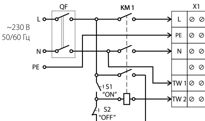
Рекомендуемая схема подключения трехфазного двигателя с использованием термозащиты
