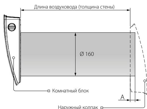
Длина воздуховода зависит от модели проветривателя (см. «Структура условного обозначения» на стр. 4).
