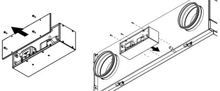
Die Entwässerungspumpe wird gemäß der Betriebsanleitung der Entwässerungspumpe über die Kabeldurchführungen des Geräts an die Stromversorgung und an das Abwassersystem angeschlossen.
