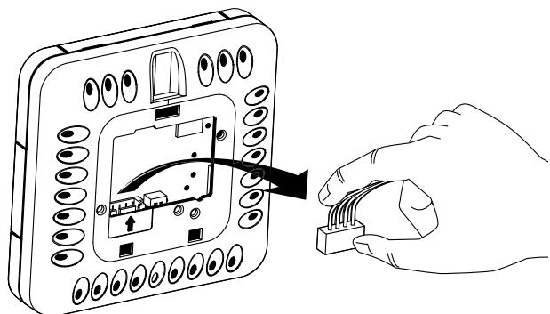
3. Выполните электрические соединения в соответствии со схемой внешних подключений.
