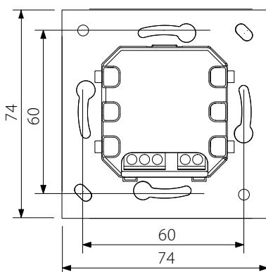
Габаритный чертеж тыльной части панели управления показан слева.
