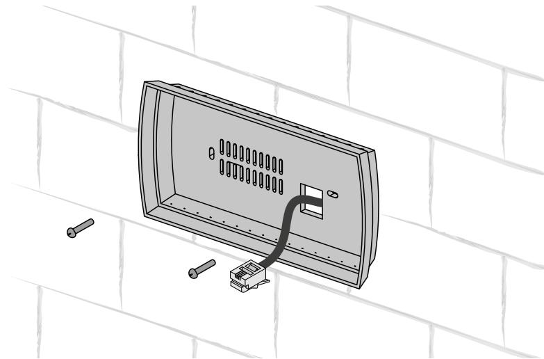
2. Подключите телефонный кабель к фронтальной части панели управления. Прикрепите переднюю часть панели управления к тыльной части корпуса с помощью винтов с потайной головкой из комплекта, как показано на рисунке ниже, и установите переднюю рамку, нажав до щелчка.
