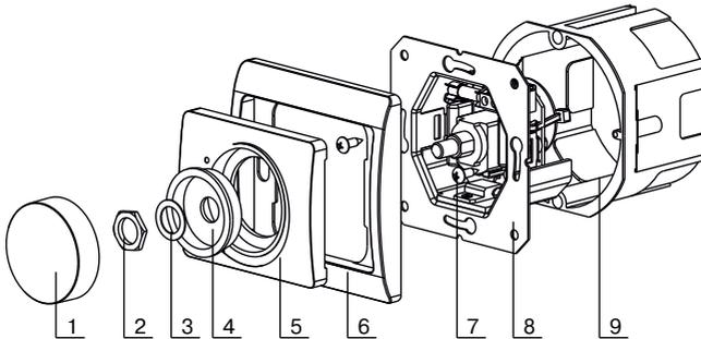
1 - Drehknopf, 2 - Mutter, 3 - Scheibe, 4 - Ring, 5 - Abdeckung, 6 - Abdeckung, 7 - Schraube, 8 - Geschwindigkeitsregler, 9 - Einbaubox.
