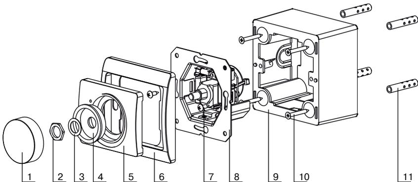
1 - Drehknopf, 2 - Mutter, 3 - Scheibe, 4 - Ring, 5 - Abdeckung, 6 - Abdeckung, 7 - selbstschneidende Schraube, 8 - Geschwindigkeitsregler, 9 - Gehäuse, 10 - Schraube, 11 - Dübel
