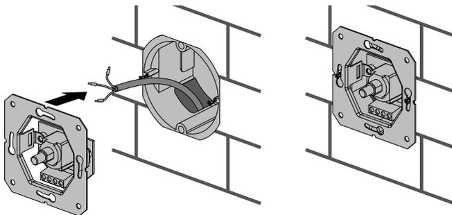
5. Bringen Sie die Frontabdeckung des Drehzahlreglers in der folgenden Weise an: setzen Sie die Frontabdeckung ein, befestigen Sie die Frontabdeckung mit Hilfe der Scheibe und der Mutter, befestigen Sie den Regelknopf.
