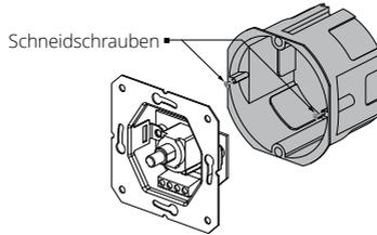
3. Setzen Sie den Einbauboxen in der Wand ein. Das gelieferte Kabel kann durch ein anderes Kabel mit einem Querschnitt von  $3 \times 0,5 \text{ mm}^2$  und einer Länge bis 10 m.
