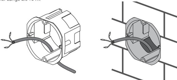
4. Schließen Sie das Kabel an den Drehzahlregler in Übereinstimmung mit dem Anschlussschema an. Setzen Sie den Drehzahlregler in den Einbaukasten mit Hilfe der Schrauben ein.
