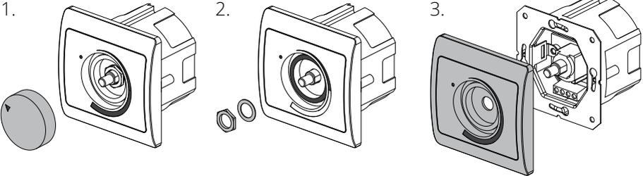
2. Drehen Sie die zwei Schneidschrauben heraus, um den Einbauboxen zu entfernen. Weiterhin trennen Sie das Steuerkabel vom Drehzahlregler. Bitte merken Sie sich die Farbkodierung der Leitungen und der Klemmen zum erneuerten Anschluss nach Montage des Drehzahlreglers.
