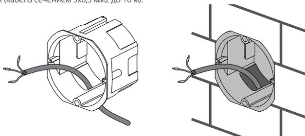
4. Подключите кабель к регулятору согласно схеме подключения. Установите регулятор в монтажную коробку с помощью саморезов.
