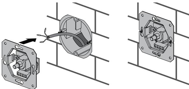
5. Смонтируйте переднюю панель регулятора следующим образом:
