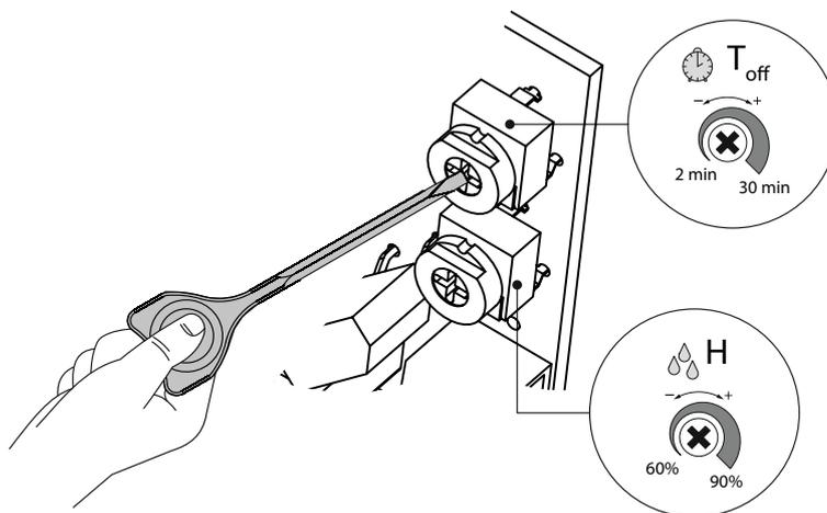
⌚  $T_{off}$  — для регулировки времени задержки выключения вентилятора поверните ручку потенциометра  $T_{off}$  по часовой стрелке для увеличения и против часовой стрелки для уменьшения времени задержки выключения соответственно (от 2 до 30 минут).
