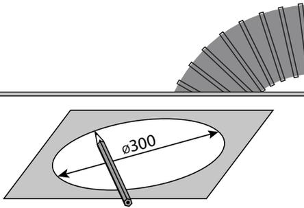
2. Из-за потолка, сверху, в отверстие просовывается гибкий канал воздуховода. Канал устанавливается на патрубок с обратным клапаном.
