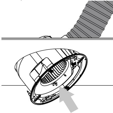
6. Закрепите вентилятор, повернув рычаги.
