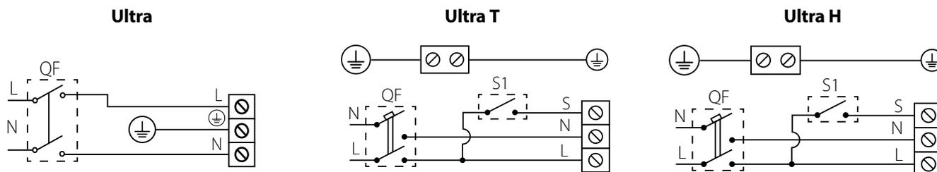
Условные обозначения клемм на схеме подключения: L — фаза; N — ноль; S1 — выключатель; QF — автоматический выключатель.
