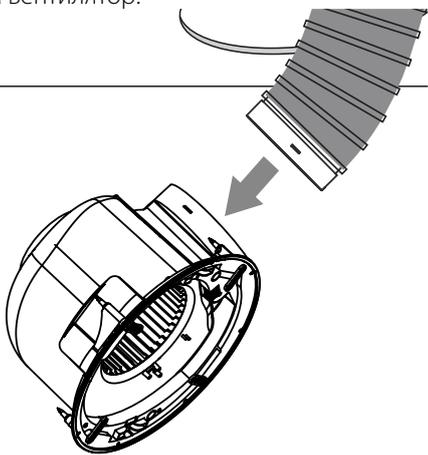
5. Вентилятор в сборе вставляется в отверстие на потолке со стороны помещения.
