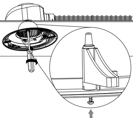
8. Установите декоративную панель (для модели Ultra приобретается отдельно) на корпус вентилятора. Монтаж панели осуществляется в соответствии с паспортом на декоративную панель.
