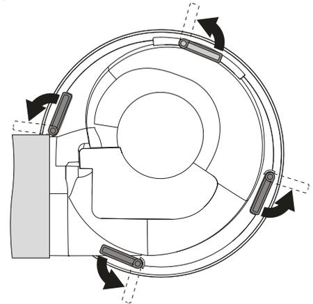
7. После установки вентилятора необходимо зажать саморезы на поворотных рычагах, чтобы прижать корпус вентилятора к потолку.
