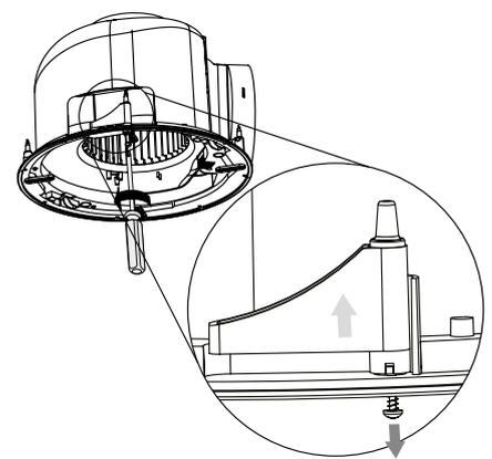
4. Патрубок с каналом устанавливается на вентилятор.
