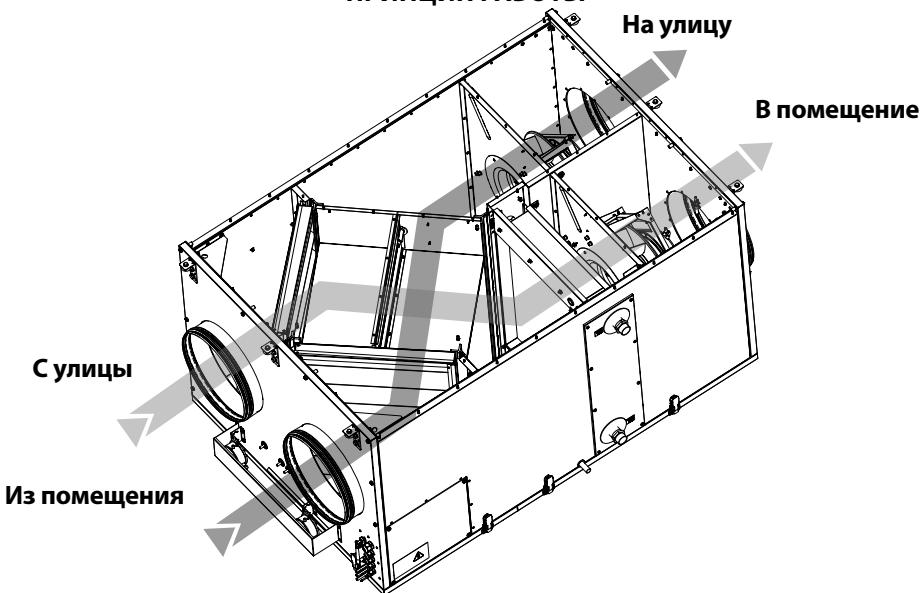
В конструкцию установки входят: приточный и вытяжной центробежные вентиляторы одностороннего всасывания с загнутыми назад лопатками рабочего колеса турбины и не требующими обслуживания EC-двигателями с внешним ротором и встроенной тепловой защитой, пластинчатый противоточный рекуператор, водяной нагреватель.
