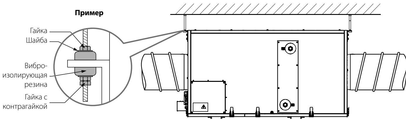
Для обеспечения наилучшей производительности установки и уменьшения аэродинамических потерь, связанных с турбулентностью воздушного потока, рекомендуется на входе и выходе из установки установить прямой участок воздуховода. Минимальные рекомендуемые длины этих прямых участков:
