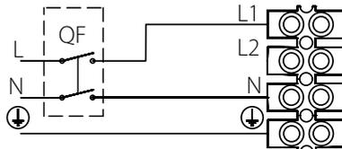
Схема подключения с переключателем режимов работы
