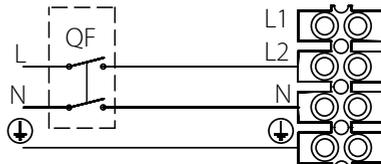
Схема подключения для работы на приток
