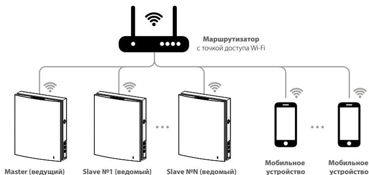
Если технические характеристики маршрутизатора не позволяют подключить необходимое количество проветривателей, можно использовать дополнительную точку доступа Wi-Fi для подключения остальных проветривателей. Также можно подключить в сеть маршрутизатора несколько ведущих устройств (Master) для организации зонального управления.
