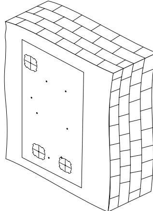
Снимите шаблон и просверлите в стене два сквозных отверстия Ø 120 мм для воздуховодов.
