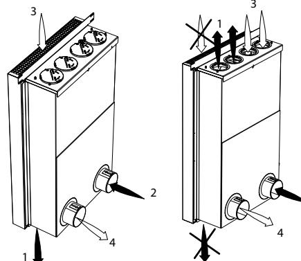
1 — приточный воздух в помещение; 2 — приточный воздух с улицы; 3 — вытяжной воздух из помещения; 4 — вытяжной воздух на улицу.
