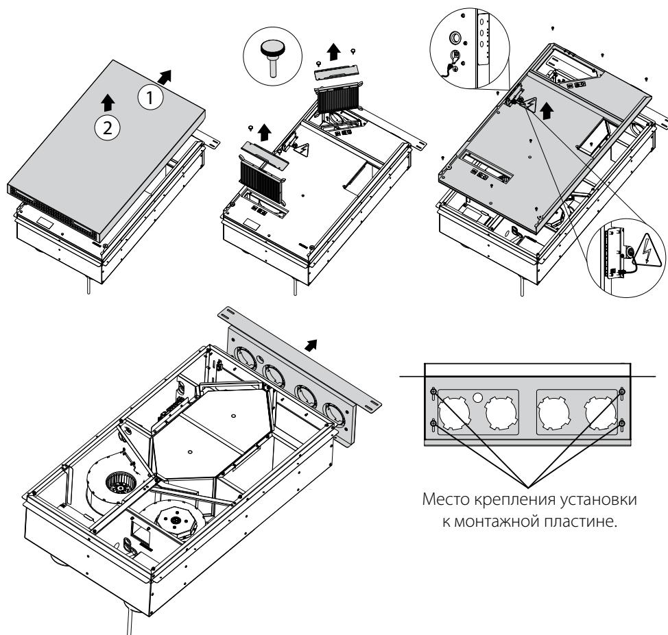
2. Прикрепить монтажную пластину к вертикальным стойкам (отрегулировав ее расположение каркаса). Для крепления используйте саморезы по металлу. Для надежной фиксации пластины рекомендуется закрепить ее к стене.
