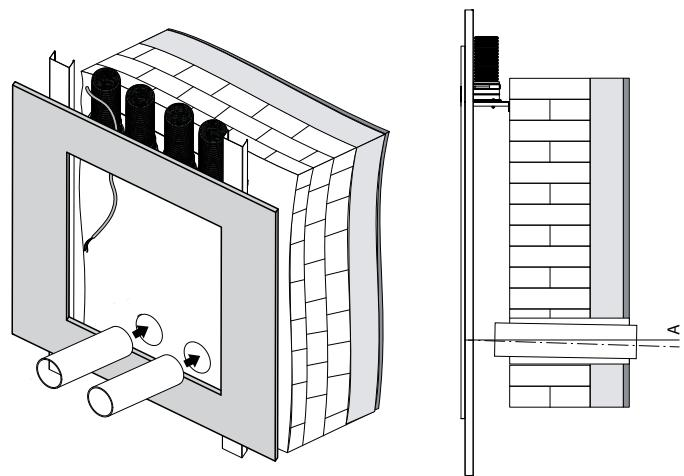
8. Поднимите установку, вставьте патрубки в установленные в стене воздуховоды.
