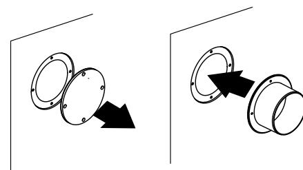
Для доступа к монтажным отверстиям снимите декоративную панель, открутите винты и снимите защитную панель, извлеките рекуператор.
