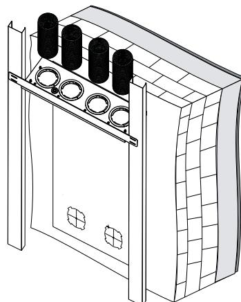
4. Демонтировать заглушки ФлексиВент. Вместо них смонтирововать фланцы ФлексиВент 0275. Надеть на воздуховоды уплотнители ФлексиВент 0575 и зафиксировать замком ФлексиВент 0375.
