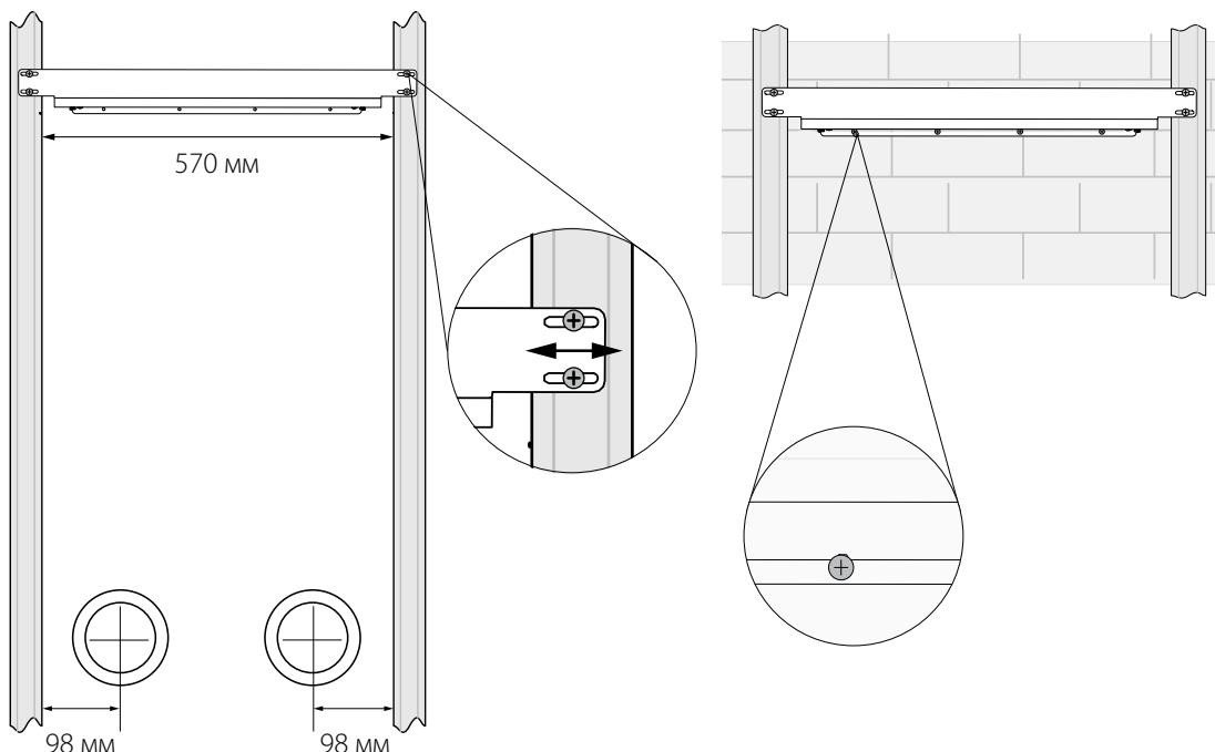
3. При необходимости проложить полужесткие воздуховоды ФлексиВент Ø75 мм внутри каркаса. Закрепите шаблон на стене на требуемом уровне. Нанесите метки под отверстия для воздуховодов. Просверлите в стене два сквозных отверстия Ø120 мм для воздуховодов.
