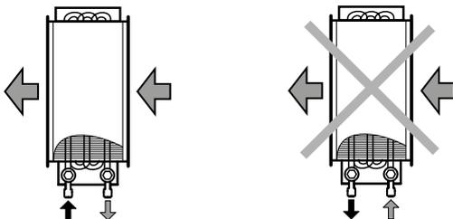
Подключение прямого и обратного трубопроводов к теплообменнику должно быть выполнено таким образом, чтобы теплообменник работал в противоточном режиме. Прямоточное подключение понижает температурный напор и уменьшает тепловую мощность теплообменника.
