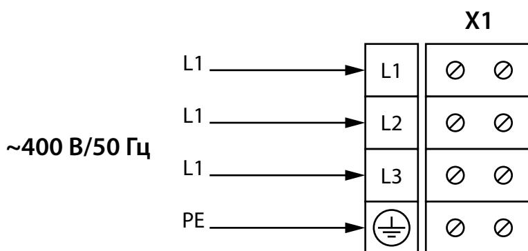
Электрическое подключение должно осуществляться на клеммнике клеммной коробки, размещенной на корпусе вентилятора, согласно схеме подключения и наименованию клемм. Наклейка с обозначением клемм находится внутри клеммной коробки. Электрические данные вентилятора указаны на ярлыке, который находится на корпусе вентилятора.
