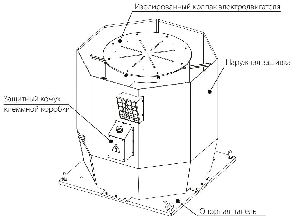
Крышный вентилятор дымоудаления состоит из сварной опорной панели, к которой крепятся:
