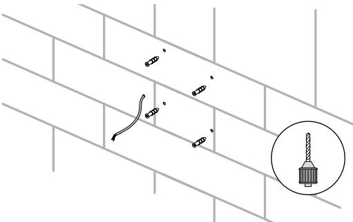
Установите вентилятор с помощью шурупов.
