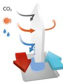
В установке **KOMFORT EC S(B)-E** применяется энтальпийный противоточный рекуператор, который возвращает тепло и влагу. Благодаря утилизации влаги энтальпийный рекуператор не производит конденсат.
