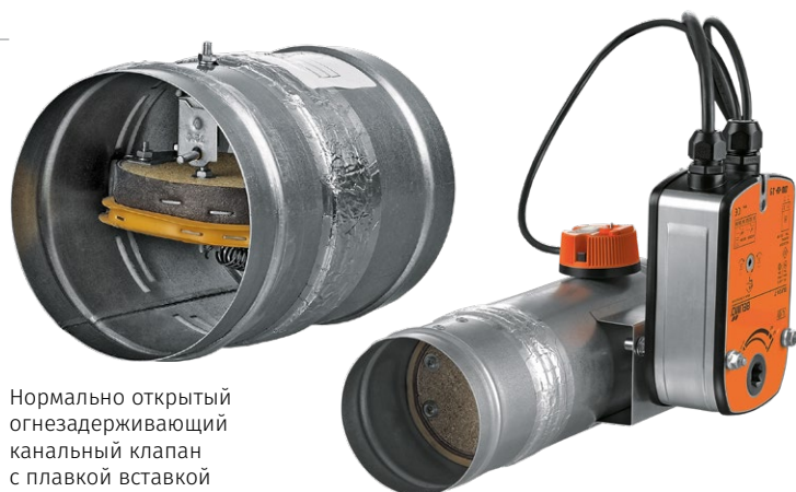
Нормально открытый огнезадерживающий каналный клапан с электроприводом, обратной пружиной и термoeлектрическим прерывателем
