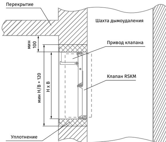
**В ГОРИЗОНТАЛЬНЫХ СТРОИТЕЛЬНЫХ КОНСТРУКЦИЯХ**
