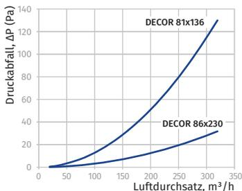
o **Endgitter mit regelbarem Luftquerschnitt DECOR**
