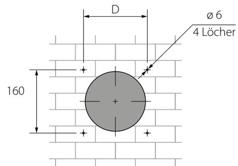
3. Die mitgelieferten Dübel (6 x 40) in die Löcher einsetzen. Demontieren Sie die Außen-Lüftungshaube, um an die Befestigungslöcher zu gelangen. Ziehen Sie dazu die Abdeckung von unten zu sich.
