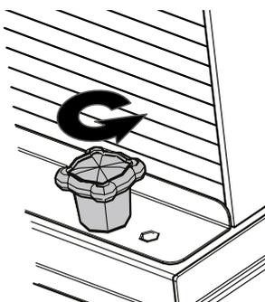
Lösen Sie die zwei Knebelmutter, welche die Halteleiste fixieren.
