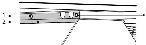
Nehmen Sie den Wärmetauscher aus der Lüftungsanlage.
