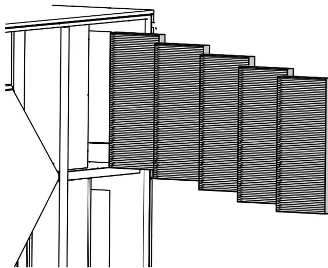
Nehmen Sie die Filterelemente aus der Lüftungsanlage.
