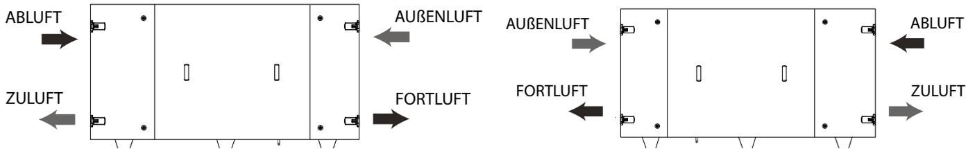
Der Anschluss der Lüftungsrohre ist mit Aufklebern in der jeweiligen Farbe angegeben: Gelb für Fortluft, Grün für Außenluft, Rot für Zuluft und Braun für Abluft.
