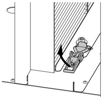
Haken Sie die beiden Riegel aus, mit denen die Halteleiste befestigt ist.
