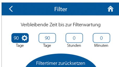
Einstellung des Filtertimers: Nach Ablauf eines voreingestellten Zeitraums (70 bis 365 Tage) wird auf der Startseite eine Warnung zum Filterwechsel angezeigt, während im Fenster **Alarmer** die entsprechenden Informationen zum erforderlichen Filterwechsel angezeigt werden. Um den Filtertimer zu deaktivieren (z. B. wenn das Gerät mit Differenzdruckschaltern ausgestattet ist), stellen Sie den Wert auf 0 Tage ein.
