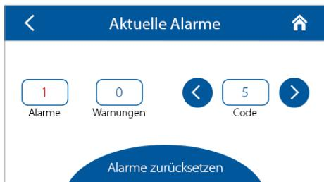
**Alarme** : Anzahl der aktuellen Alarme. Weist auf einen schwerwiegenden Fehler im Betrieb hin. Die Lüftungsanlage wird zwangsweise ausgeschaltet. Die Alarme müssen manuell zurückgesetzt werden.
