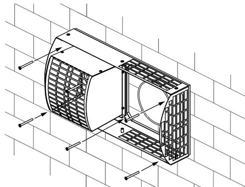
6. Setzen Sie die Abdeckung auf das Gehäuse und befestigen Sie diese von unten mit den mitgelieferten Schrauben.
