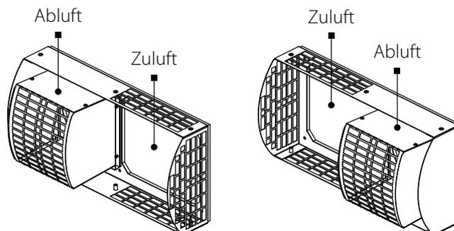
4. Markieren Sie die Bohrungslöcher mit Hilfe des Gehäuses der Außenhaube. Bohren Sie 50 mm tiefe Löcher für die 6x40 Dübel. Setzen Sie die mitgelieferten Dübel in die Löcher ein.
