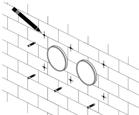
5. Befestigen Sie das Gehäuse mit den mitgelieferten Schrauben M4x40 an der Wand.
