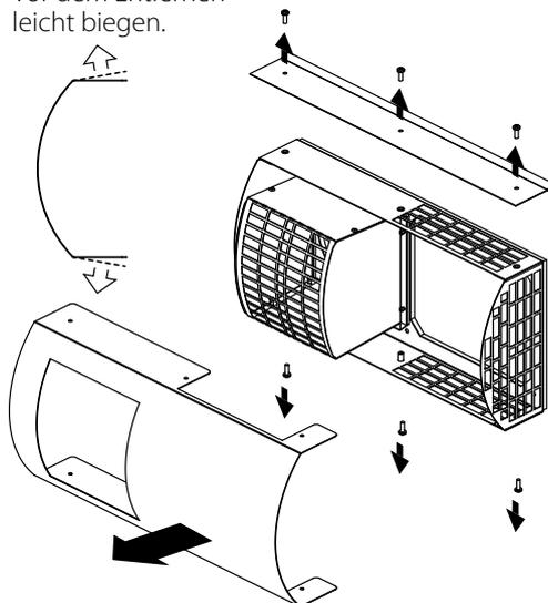
3. Falls erforderlich, kann die Position der Außenhaube entsprechend der Lage der Lüftungsröhre angepasst werden.
