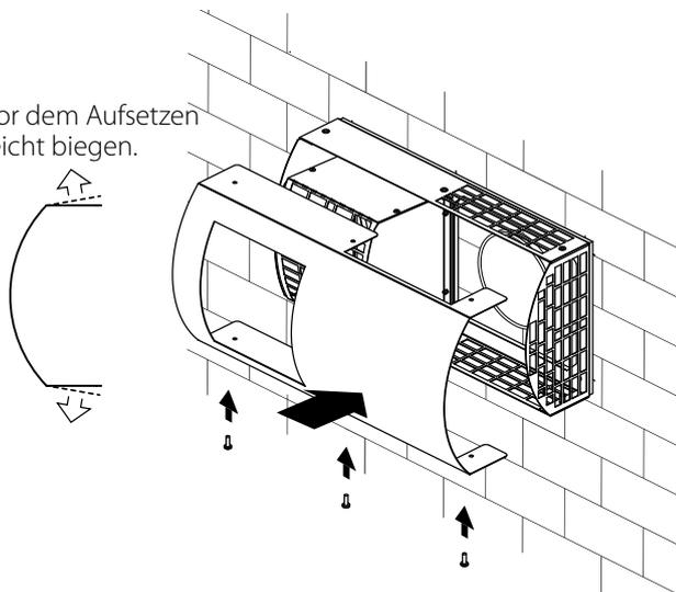
7. Montieren Sie die Schutzleiste oben auf die Außenhaube.
