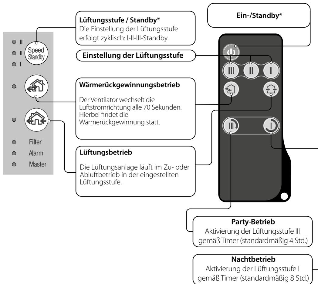
\* Die **Standby-Taste** schaltet das Gerät nicht aus, sondern nur in den Standby-Betrieb. Während der Wartung muss das Gerät unbedingt ausgeschaltet werden.
