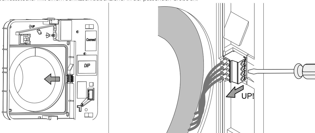
3. Entfernen Sie das Schallschutzmaterial aus dem Lüftungsrohr und entfernen Sie anschließend die Patrone oder die Ventilatoreinheit und die Wärmetauschereinheit.
