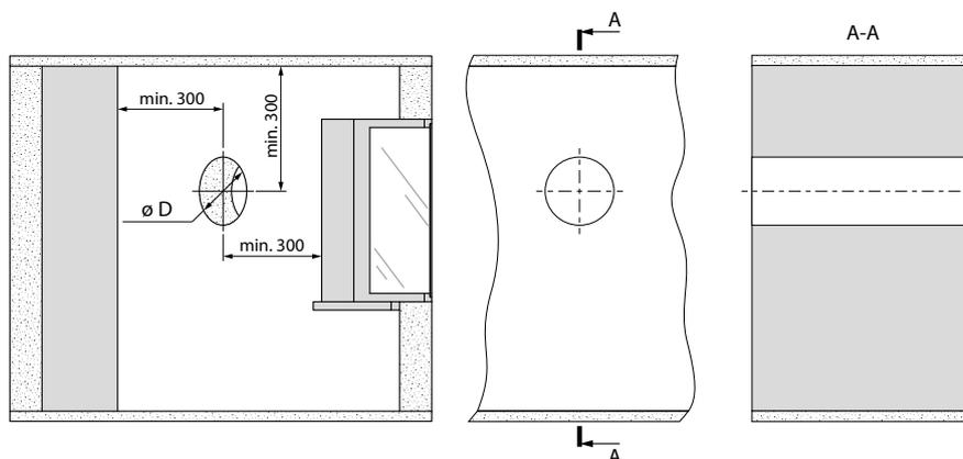
2. Setzen Sie das Lüftungsrohr in die Wand ein. Verwenden Sie die mitgelieferten Montagekeile für eine einfachere Montage. An der Außenwand muss das Lüftungsrohr um den Abstand A aus der Wand herausragen, der für die Montage der Außenhaube erforderlich ist. Die Außenabmessungen der Außenhaube, die Größe des erforderlichen Überstands des Lüftungsrohres außerhalb der Wand A und die Montagereihenfolge der Haube sind in der Betriebsanleitung der Außenhaube angegeben.
