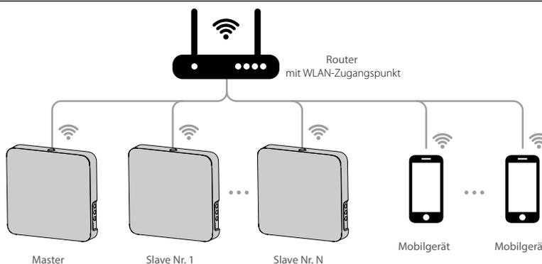
Falls die Kapazität des Routers für den Anschluss einer erforderlichen Anzahl an Lüftungsanlagen nicht ausreichend ist, kann ein zusätzlicher WLAN-Zugangspunkt für die restlichen Lüftungsanlagen verwendet werden. Optional können einige Master-Anlagen an das Netzwerk des Routers angeschlossen werden, um eine Zonensteuerung zu ermöglichen.
