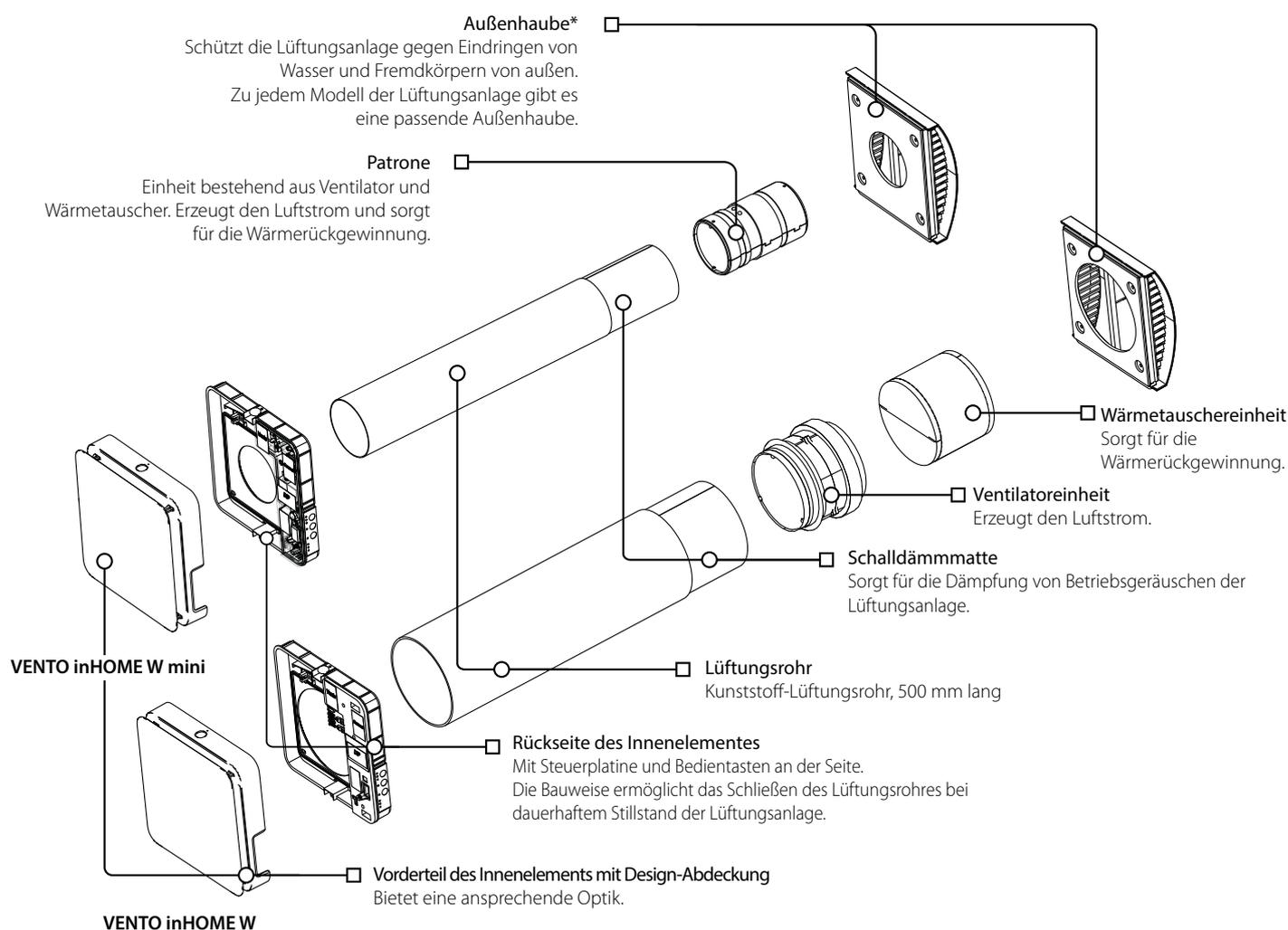
\* In allen Abbildungen dieser Betriebsanleitung ist als Beispiel die Außenhaube AH-10 abgebildet; die Lüftungsanlage kann mit anderen Außenhaubenmodellen geliefert werden.
