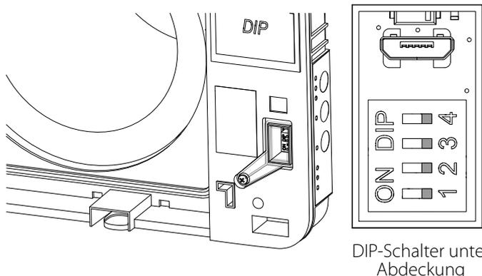
Vor der ersten Inbetriebnahme der Lüftungsanlage stellen Sie die Lüftungsanlage mit dem DIP-Schalter auf der Steuerplatine ein. Um auf den DIP-Schalter zugreifen zu können, nehmen Sie das Vorderteil des Innenelements ab und öffnen Sie die Gummi-Abdeckung, welche den Schalter abdeckt.
