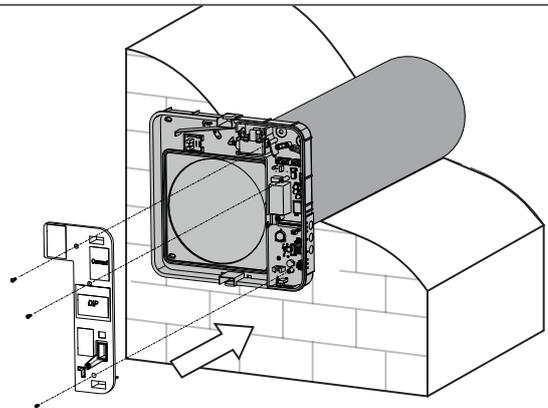
10. Setzen Sie die Patrone und die Wärmetauschereinheit in das Lüftungsrohr ein, wie in der Abbildung unten gezeigt. Schließen Sie dann den Anschlussstecker wie durch den Pfeil angegeben an die Steuerplatine an.
