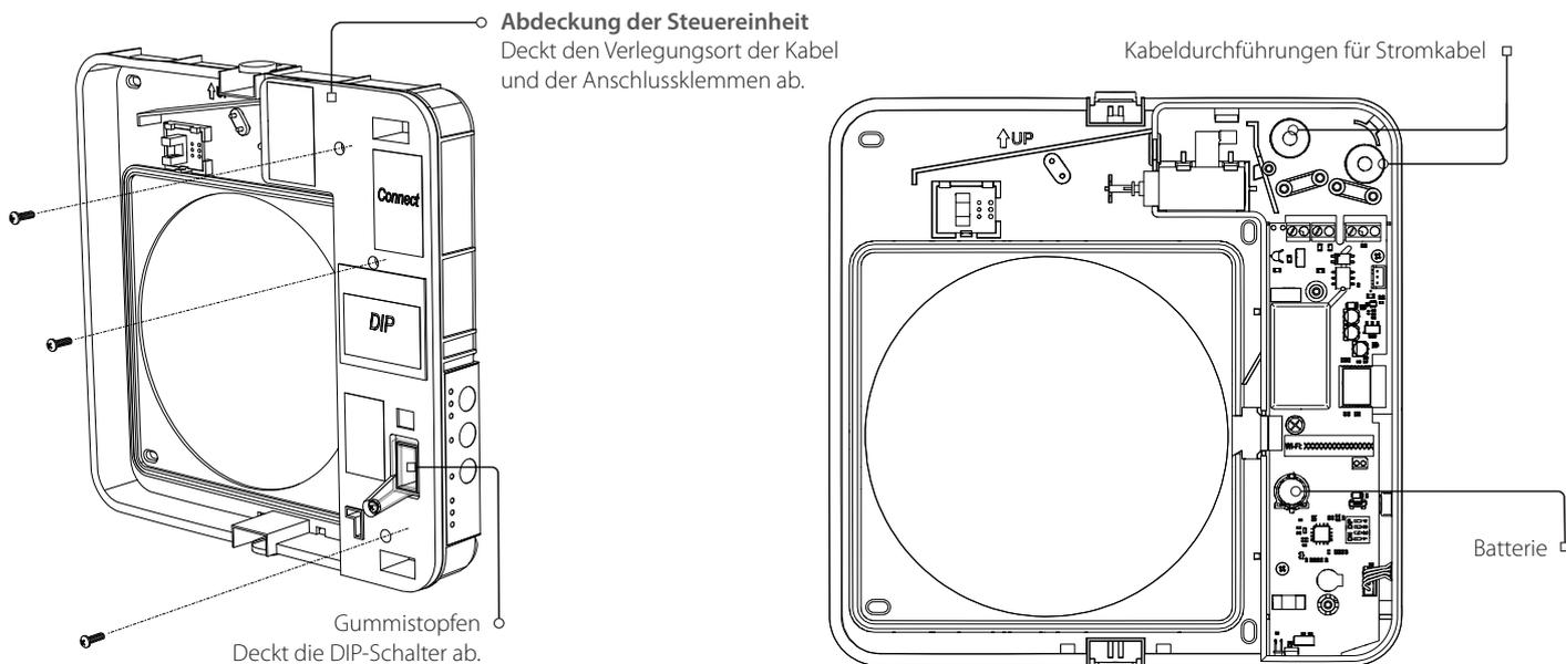
7. Befestigen Sie die Rückseite des Innenelementes mit den im Befestigungsset der Lüftungsanlage enthaltenen Schrauben an der Wand.
