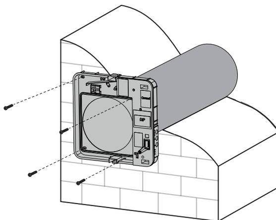
8. Verlegen Sie das Stromkabel wie hier abgebildet. Schließen Sie die Lüftungsanlage in Übereinstimmung mit dem externen Anschlusschema an die Stromversorgung an (siehe Abschnitt «Netzanschluss»). Fixieren Sie das Stromkabel mit einer Kabelklemme.
