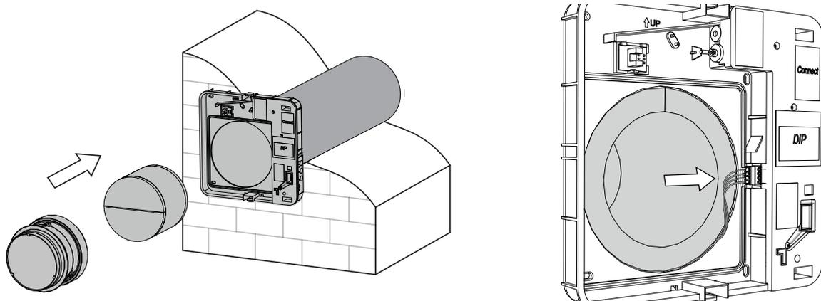
Setzen Sie die Schalldämmmatte in das Lüftungsrohr ein. Rollen Sie die Schalldämmmatte mit der Papierseite nach außen zeigend zusammen und passen Sie die Rolle dem Durchmesser des Lüftungsrohres an. Setzen Sie die Rolle bis zum Anschlag an die Patrone in das Lüftungsrohr ein. Markieren Sie das überstehende Ende der Schalldämmmatte bündig mit dem Lüftungsrohr und schneiden Sie es an der Markierung ab. Setzen Sie dann die angepasste Schalldämmmatte in das Lüftungsrohr ein.
