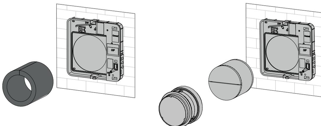
4. Reinigen Sie die Filter nach Bedarf. Nach Ablauf der eingestellten Anzahl an Tagen leuchtet die Filterwechselanzeige (Filter) auf. Abhängig vom Staubgehalt der Luft kann sich die Betriebsdauer der Lüftungsanlage bis zur nächsten Filterreinigung unterscheiden. Der Zeitraum, nach dem die Filterwechselanzeige aufleuchtet, kann mit der mobilen App auf 70 bis 365 Tage eingestellt werden (standardmäßig ist der vom Hersteller empfohlene Wert von 90 Tagen eingestellt).
