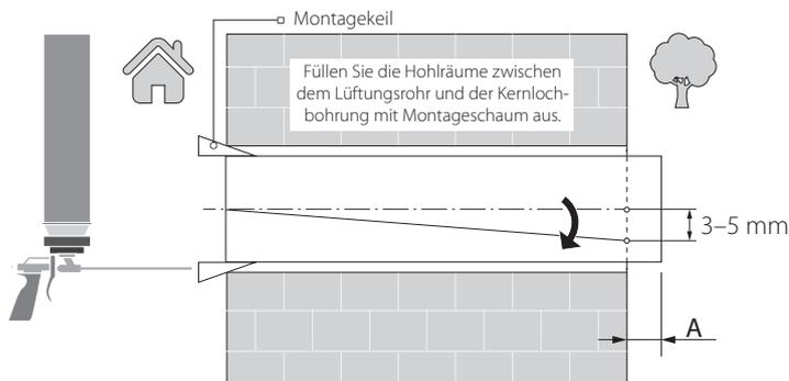
Setzen Sie das Lüftungsrohr mit einer Neigung nach Außen von 3–5 mm ein.
