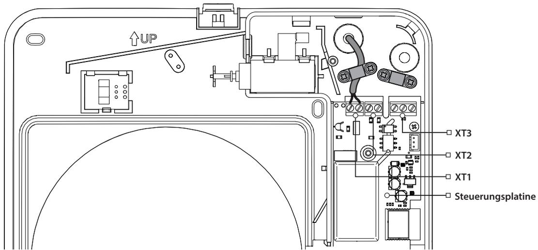
9. Setzen Sie nach dem Anschluss die Abdeckung der Platine wieder ein.
