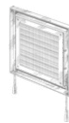
Manuelle Steuerung des freien Querschnitts (R)
