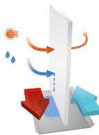
В установке **KOMFORT Ultra L 250-E (white)** применяется энтальпийный пластинчатый рекуператор перекрестного тока, который возвращает тепло и влагу. Благодаря передаче влаги энтальпийный рекуператор не производит конденсат.
