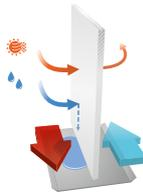
В установке **KOMFORT Ultra S 250-E (white)** применяется энтальпийный пластинчатый рекуператор перекрестного тока, который возвращает тепло и влагу. Благодаря передаче влаги энтальпийный рекуператор не производит конденсат.
