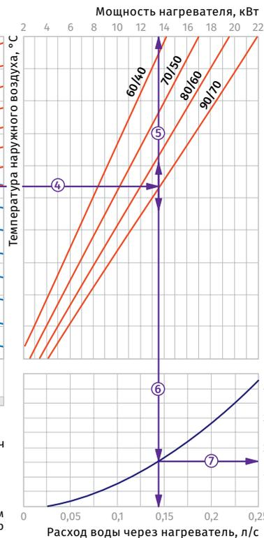
**Пример расчета параметров водяного нагревателя**
