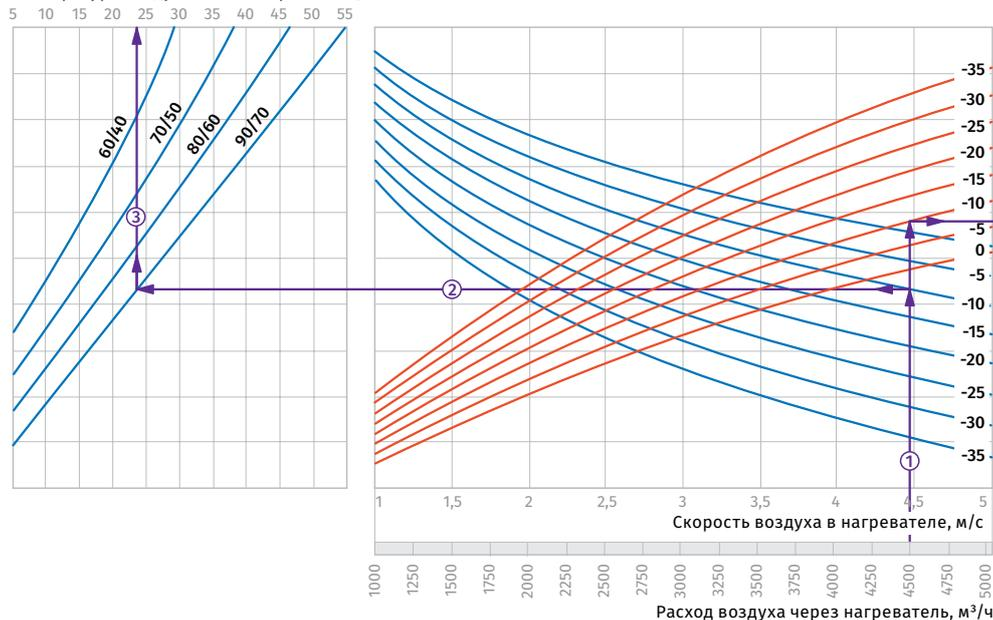
**Пример расчета параметров водяного нагревателя**
