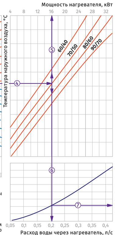
**Пример расчета параметров водяного нагревателя**
