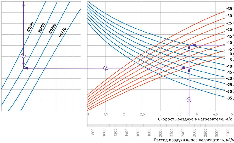
**Пример расчета параметров водяного нагревателя**
