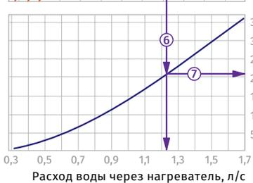
**Пример расчета параметров водяного нагревателя**
