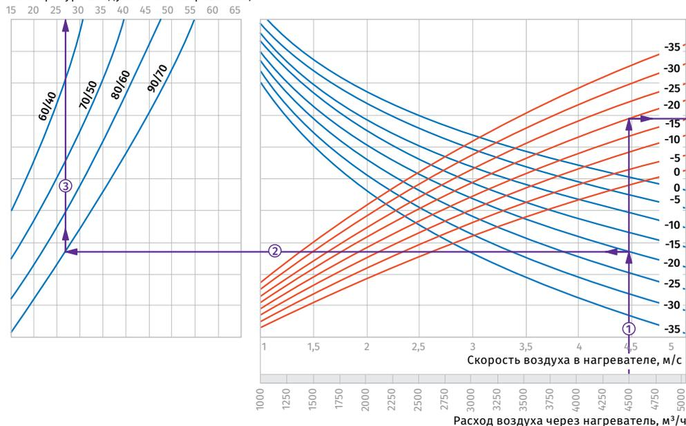
**Пример расчета параметров водяного нагревателя**
