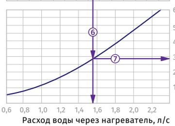
**Пример расчета параметров водяного нагревателя**
