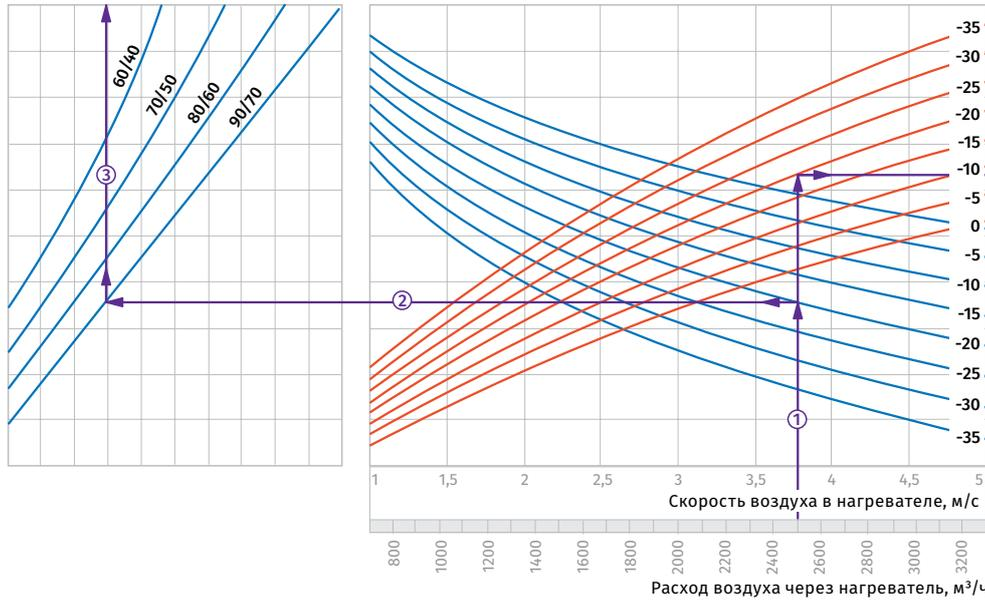
**Пример расчета параметров водяного нагревателя**
